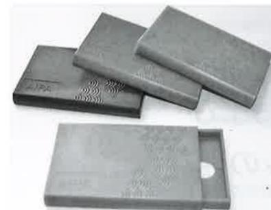
図5 牛乳パック配合プラスチックを用い作成したカードケース
